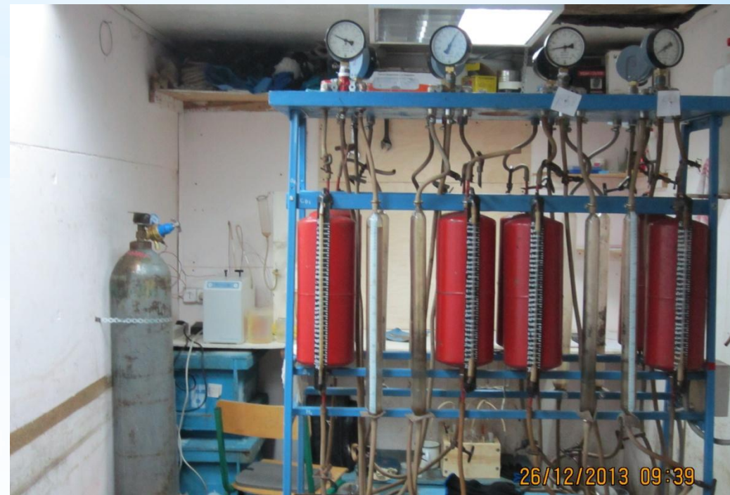
Сборка дегазационной установки в полевых условиях на Амаамском месторождении (Чукотка)
